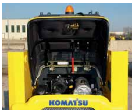
Kryt motoru: rychlá kontrola motoru
